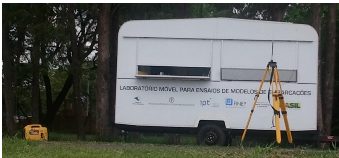
Figura 68. Instalação do laboratório móvel (gerador à esquerda e antena de rádio à frente)
