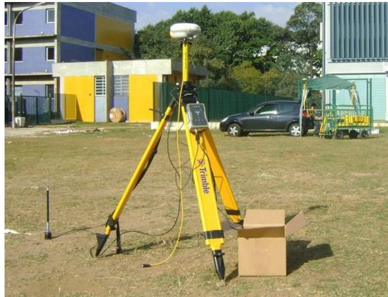
Figura 1. Sistema DGPS Trimble®. Base fixa em destaque (R4 mais rádio) e antenas móveis ao fundo
