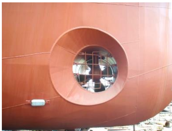
Figura 18. Exemplo de propulsor em túnel, extraído de (PRECIADO, 2012)
