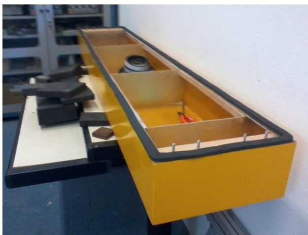
Figura 63. Vedação na região da tampa da embarcação com fita adesiva de neoprene de 6mm
