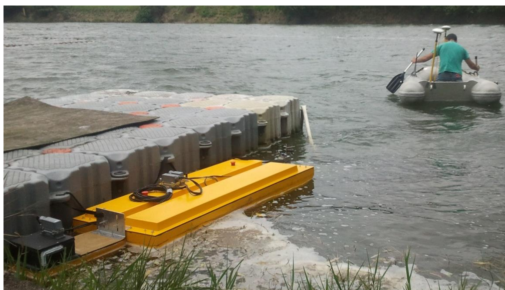
Figura 70. Sistemas atuando em paralelo, embarcação com acionamento à esquerda e aquisição do DGPS à direita
