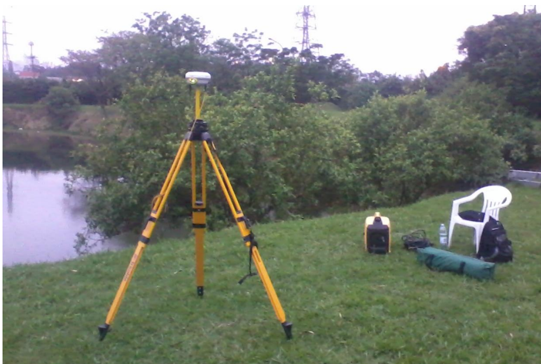
Figura 67. Fixação de estacas para o levantamento de um ponto preciso para a base fixa (procedimento experimental de cerca de 4 a 5 horas)
